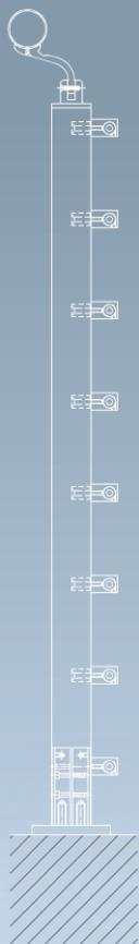
Il sistema di Parapetto composto da profili in lega di alluminio appartenente alla serie OVER è un sistema con correnti orizzontale in lega di alluminio 6063 costituito da montanti di sezione 50x30 mm.
