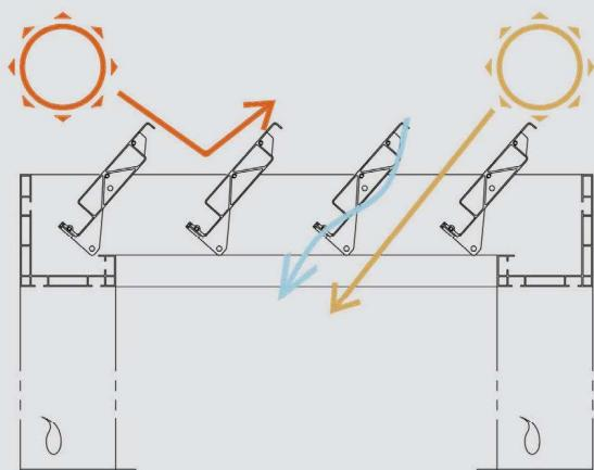
La possibilità di inclinare le doghe in alluminio permette di lasciar filtrare il sole oppure di creare una zona ombreggiata. L'apertura delle doghe permette inoltre di far circolare una piacevole brezza.
