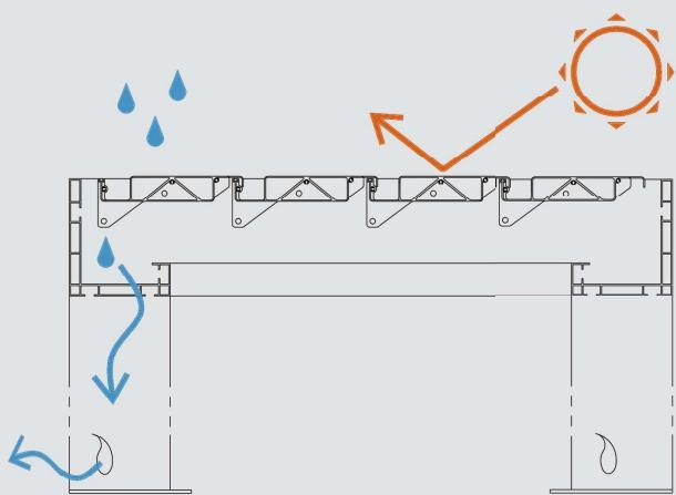
Il sistema portante perimetrale con grondaia integrata permette di raccogliere l'acqua piovana e convogliarla all'interno delle colonne per poi essere scaricata tramite le lavorazioni alla base delle colonne con foro a goccia che contraddistingue il marchio Lesko.
